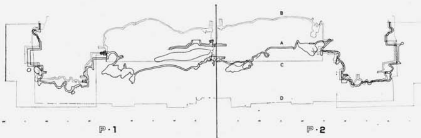
図15 水平断面図 (A : 高さ1300mm ; B : 高さ2600mm) および基底部 (C) と最頂部 (D) の平面図 Fig. 15 Diagram of horizontal sections (A : H. 1300mm ; B : H. 2600mm) and outlines of base (C) and cornice (D).
